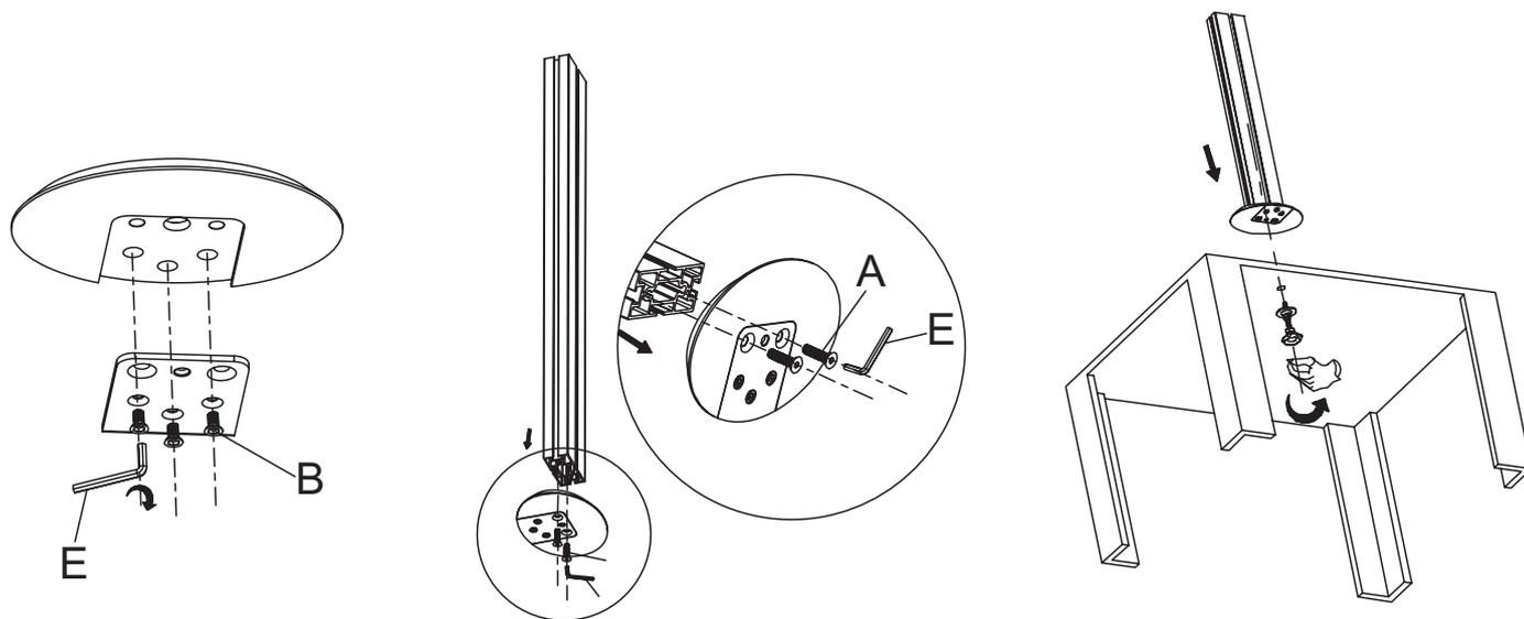
Необходимо предварительно подготовить отверстие в столешнице диаметром 10 мм (мин) - 50 мм (макс)
