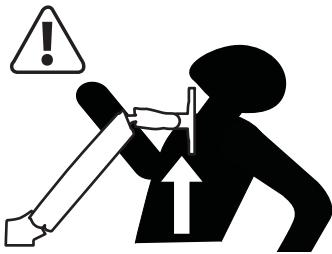
**NL** WAARSCHUWING! Gevaar door opgeslagen energie: het hefmechanisme van het werkoppervlak staat onder spanning en verplaatst zich zelfstandig snel omhoog wanneer de bevestigde apparatuur wordt verwijderd. Verwijder apparatuur daarom ALLEEN nadat de arm in de hoogste stand is gezet! Als u deze instructie niet opvolgt, kan dit tot ernstig persoonlijk letsel en/of beschadiging van de apparatuur leiden!
