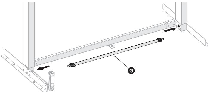
После установки снова затяните пластиковые барашки на стержне.
